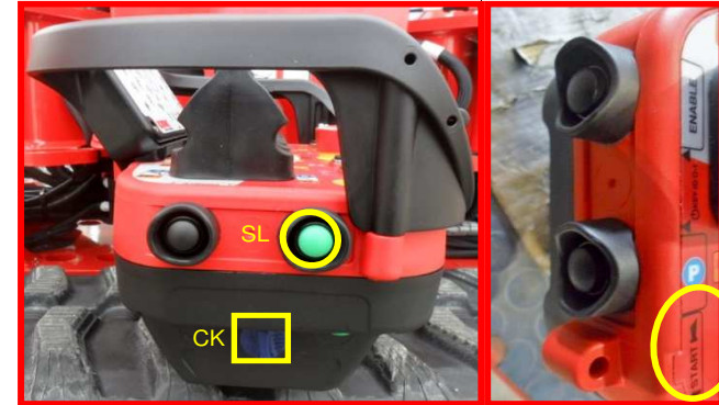
Afbeelding 7: contactsleutel en knop koppeling afstandsbediening.
