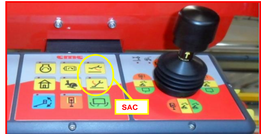
Afbeelding 49: knoppen automatische stabilisatie/destabilisatie bedieningspost in de korf.
