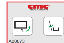
Afbeelding 58: knoppen voor beweging jib en rotatie korf.
