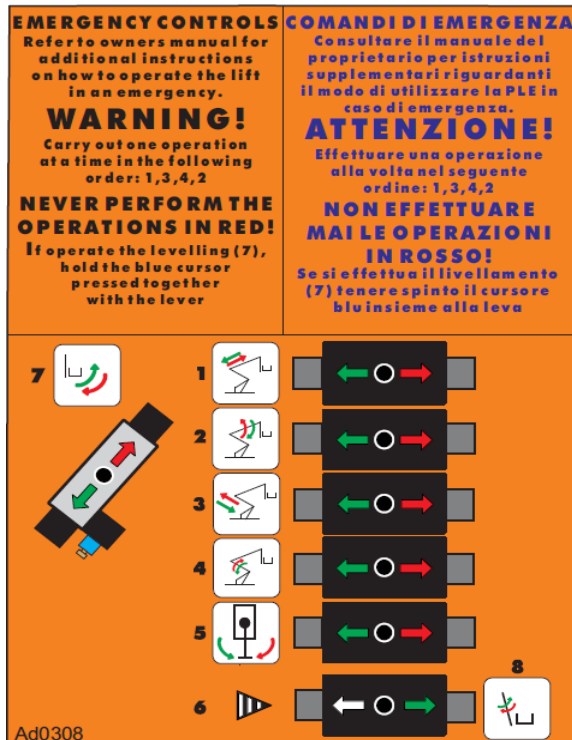
Afbeelding 89: manoeuvres noodgevallen bovenbouw.
