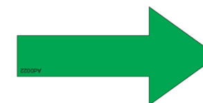
Afbeelding 74: pijlen op rupsbanden voor aanduiding grote verplaatsingen.
