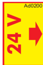
Afbeelding 55: aanduiding stopcontact in de korf.
