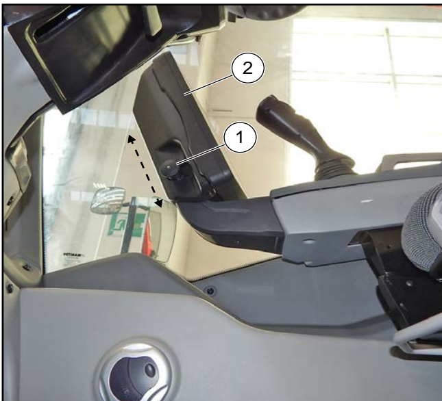
Afbeelding 56: Stelknop voor hoogte-instelling van het display
