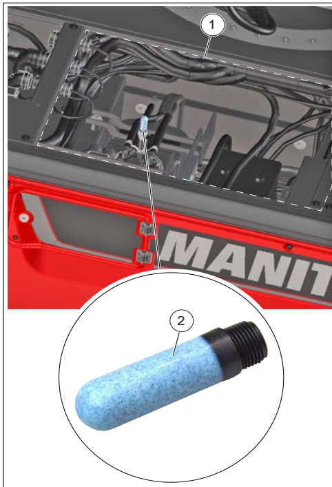
Afbeelding 205: De ontluchter van de DEF-tank vervangen
