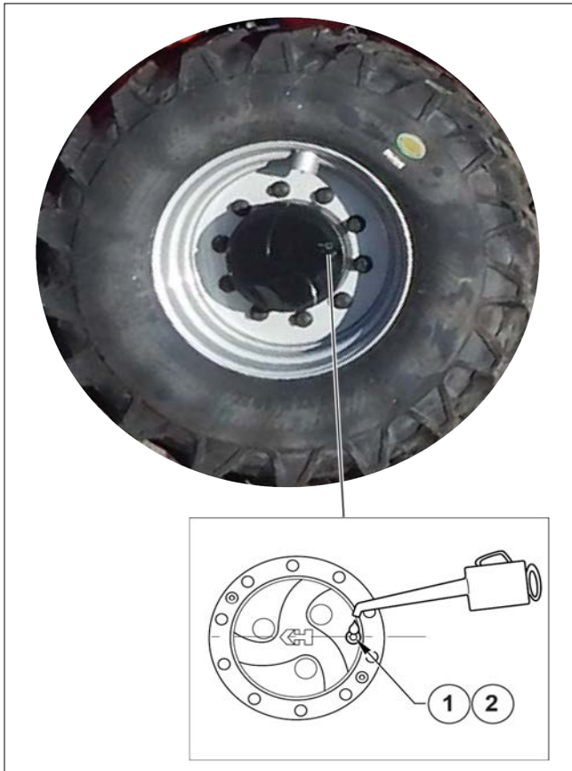
Afbeelding 162: Oliepeil van voor- en achterwielreductoren controleren
