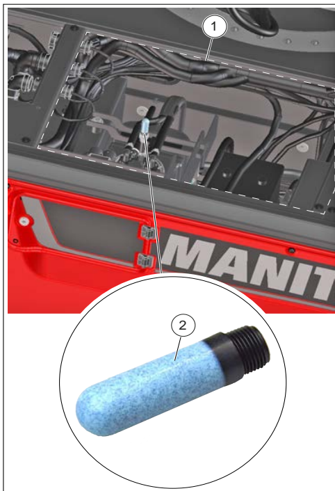
Afbeelding 205: De ontluchter van de DEF-tank vervangen
