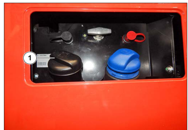
Afbeelding 121: De brandstoftank vullen
