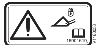
35 WAARSCHUWING! Vergrendeling van hulpstuk controleren (Artikelnummer in de VS: 11111506)
