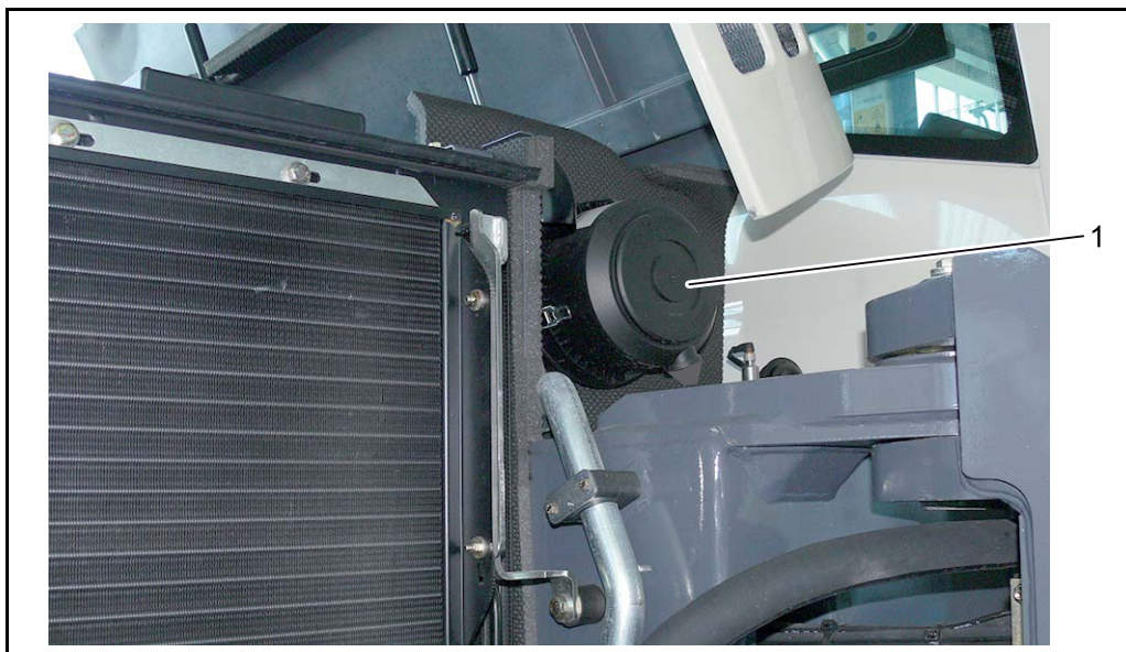
Afb. 6-9 Onderhoud van de luchtfilter
