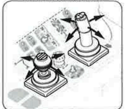
DE STAAT VAN DE MANIPULATORBALGEN CONTROLEREN
